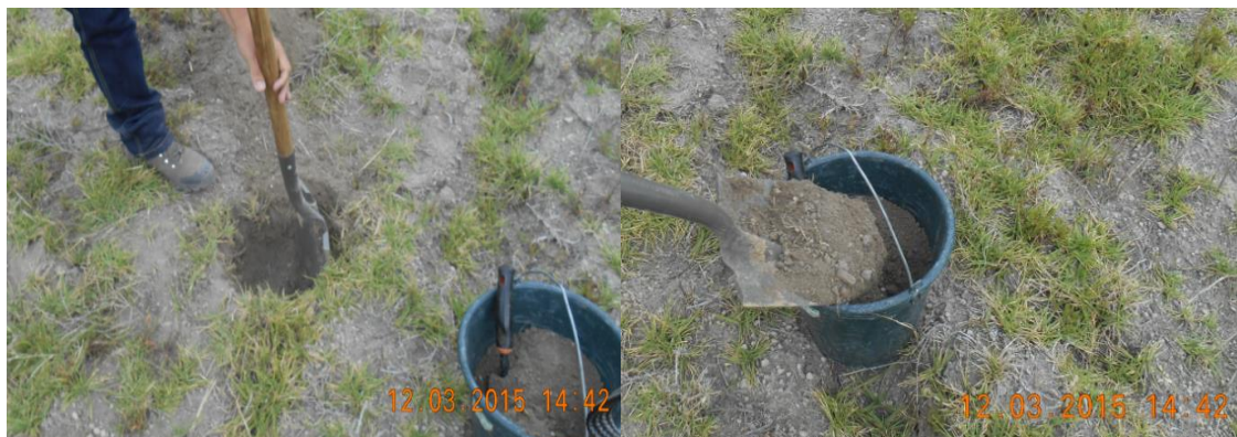
Fotografía N° 5 Toma de muestras de suelo
